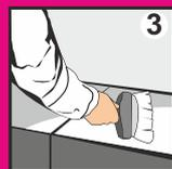
**3** Перед проведением штукатурных работ участки, поражённые плесневыми грибами, очистите стальной щёткой и обработайте фунгицидным грунтом БОЛАРС «Антиплесень». Сильновпитывающие поверхности увлажните или обработайте грунтом БОЛАРС «Глубокого проникновения».
