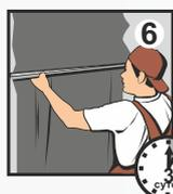
**6** При выполнении штукатурных работ смесь нанесите шпателем на основание слоем от 5 до 20 мм и разровняйте с помощью правила. При толщине слоя более 20 мм рекомендуется использовать штукатурную сетку. Общая толщина слоя не должна превышать 50 мм. Для получения ровного гладкого слоя поверхность смеси после начала схватывания на стене заглайте металлическим шпателем. Дальнейшие отделочные работы по штукатурному покрытию проводить через 3 суток. Полная прочность достигается через 28 суток.
