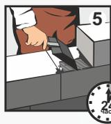
**5** При выполнении кладочных работ раствор нанесите на монтажные поверхности блока (кирпича, камня) при помощи зубчатого шпателя или специальной кельмы. Следующий блок (кирпич) уложите на раствор и прижмите друг к другу поворотным движением, формируя необходимую ширину шва. Ширина шва зависит от формы и размера кладочных элементов (от 5 до 15 мм). Дальнейшие отделочные работы по готовой кладке проводить не ранее чем через 24 часа.
