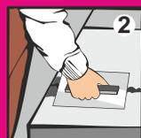
**2** Перед выполнением кладочных работ при необходимости выровняйте основание смесью БОЛАРС «Кладочная». Перед укладкой первого ряда кладки обработайте основание грунтовочными составами БОЛАРС, соответствующими Вашему типу поверхности.
